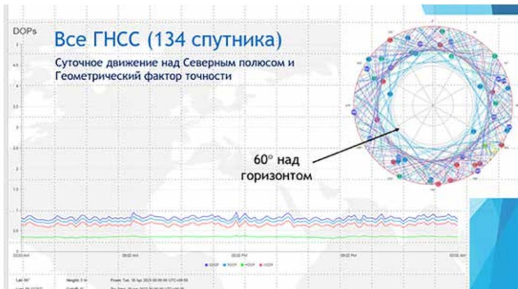
Рисунок 3 — Графики суточного движения спутников ГНСС, значения геометрических факторов на Северном полюсе
