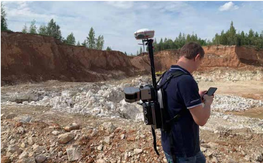
Фотография 6 — Сканер размещён на крепление рюкзачного типа
