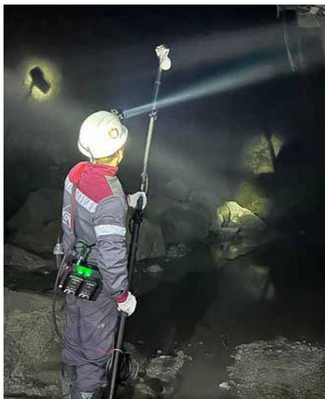
Фотография 9 — Сканирование в подземных выработках с использованием вехи
