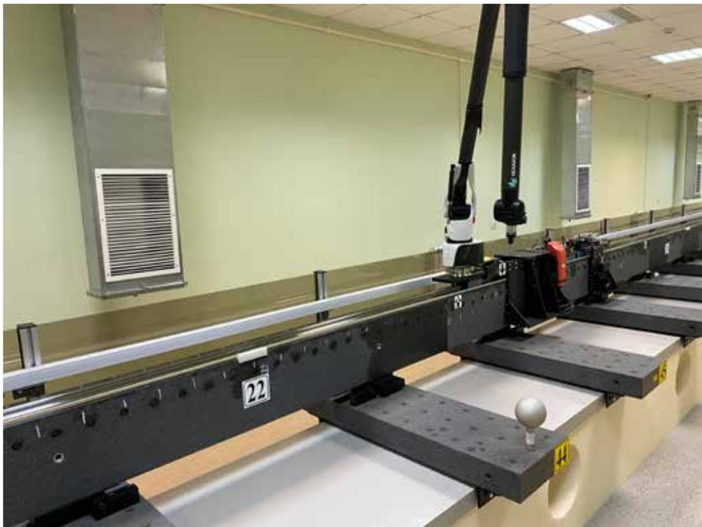
Фотография 2 — Эталонный измерительный комплекс длины в диапазоне до 60 м в части трёхмерных измерений из состава ГЭТ 199-2018 часть 1
