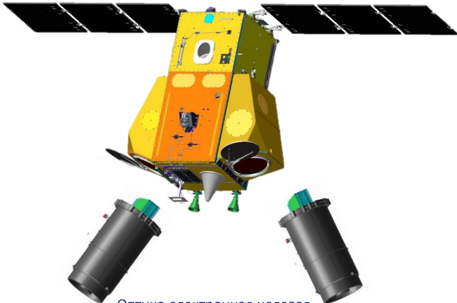
Оптико-электронная целевая аппаратура (2 шт., установка под углом)
