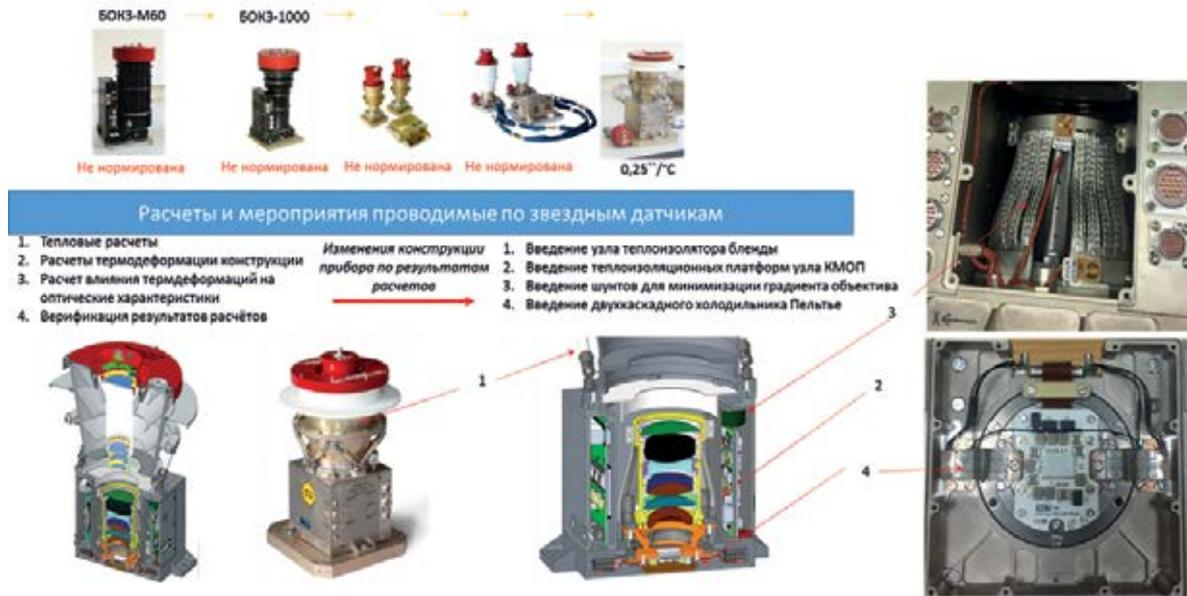
Рис. 3. Доработки БОКЗ в части выполнения требований по ТОКО
