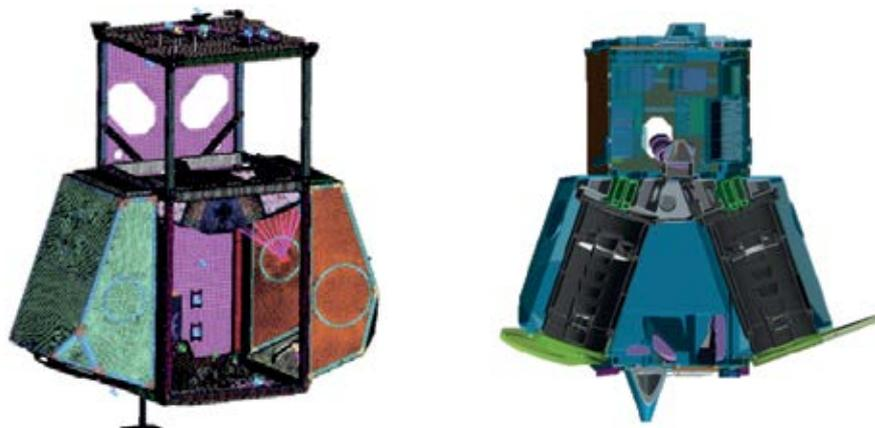
Рис. 6. КЭМ и твердотельная модель МКА «АИСТ-2Т»
