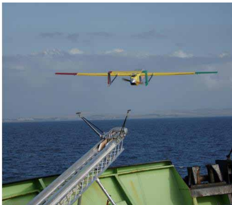
Рисунок 2 — БПЛА типа NOCS, тестируемого для применения в рыбоборозведке
