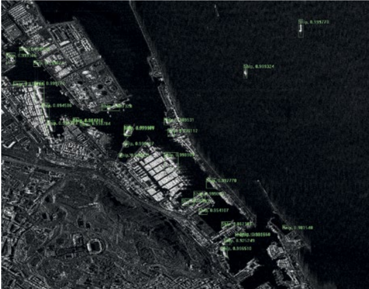
Рисунок 5. Пример мониторинга портовой акватории на предмет наличия кораблей (фрагмент снимка TerraSAR-X, город Барселона, Испания).
