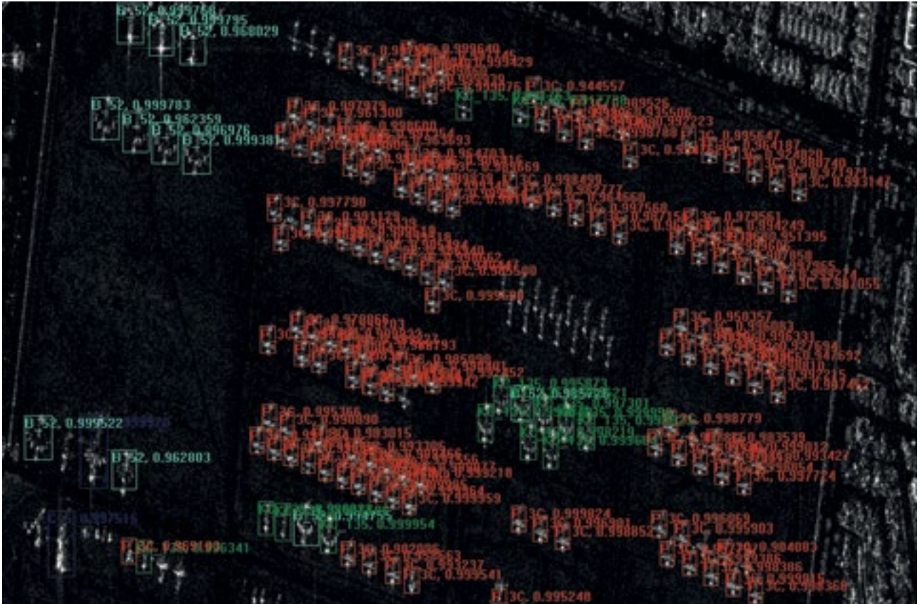
Рисунок 3. Пример обнаружения и классификации самолётов на РЛИ (фрагмент снимка Кондор-Э, авиабаза Дэвис-Монтен, город Тусон, США).
