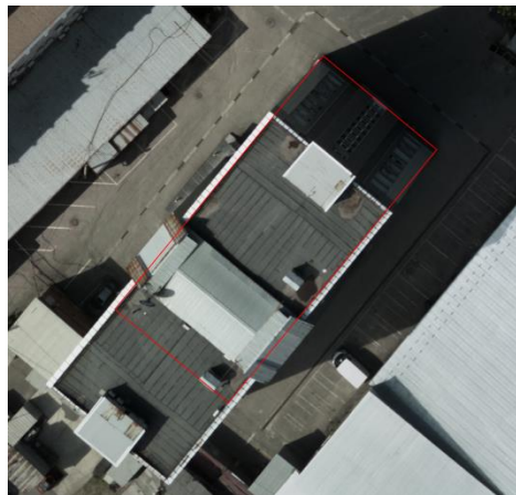
По материалам ЦОФП крупных масштабов с перекладыванием снимков для определения основания здания
