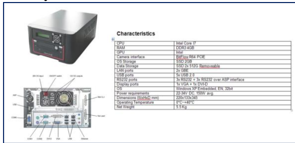
Figura 8: Sistema de almacenamiento de datos
