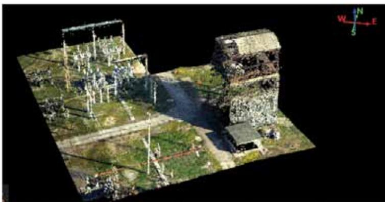
В процессе автоматической обработки плотных облаков точек были построены цифровые модели местности и цифровые модели рельефа. Последующая проверка и анализ полученных цифровых моделей местности показала их высокую степень детализации и метрическую
